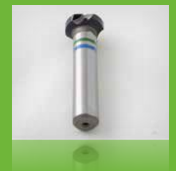
Chwyt TRICON - brak możliwości przekręcenia w futrze
