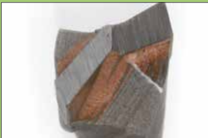
Die Hartmetallplatte ist diamantgeschliffen und bietet universellen Einsatz.
